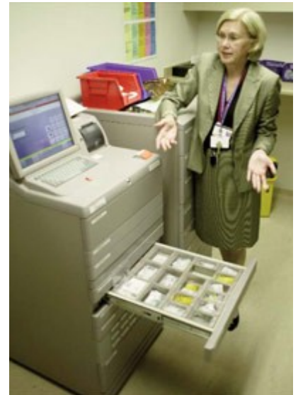
Les unités Pyxis MedStations réparties dans l'hôpital « communiquent » avec le système PillPickMD et sécurisent l'accès aux narcotiques et aux médicaments contrôlés.
